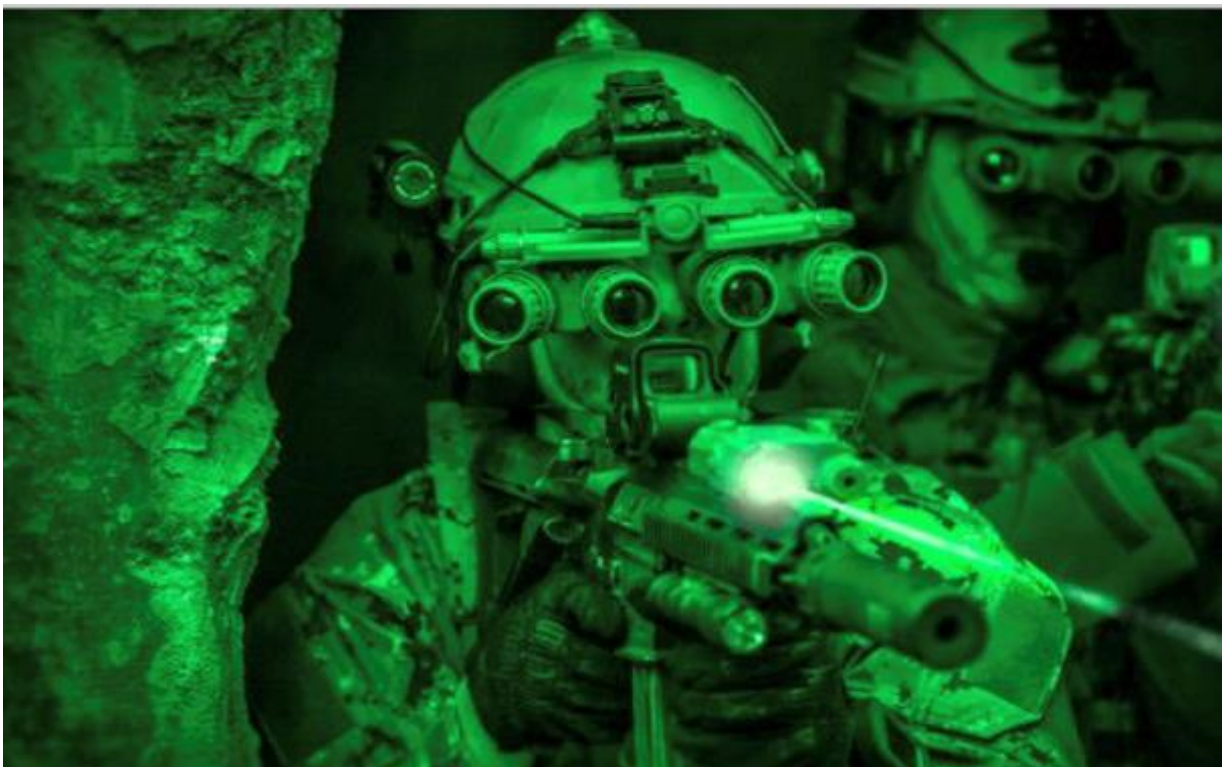
Abbildung 18 - Soldat mit einem auf dem Gefechtshelm montierten und vor die Augen geschwenkten L 3 Quad-Eye-NVG-System sowie Infrarot-Ziellaser (Bildlizenz by GettyImages).
