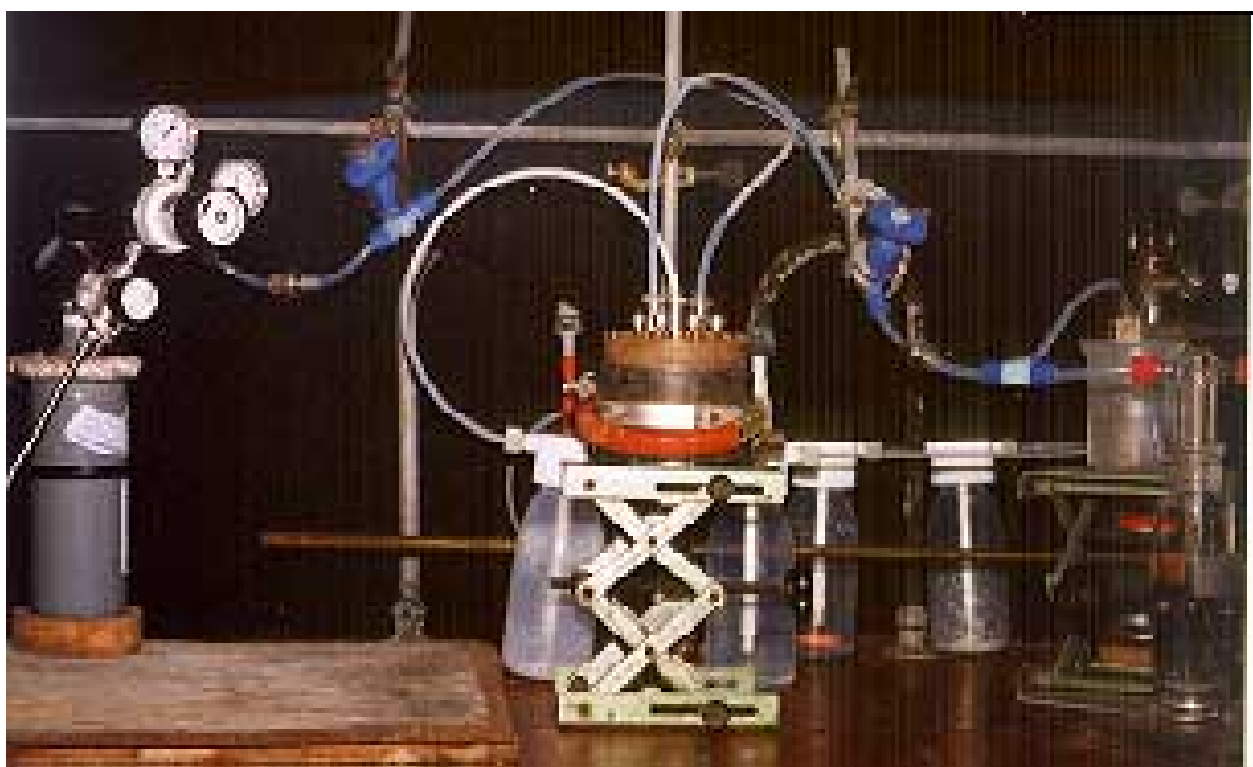
Abb. 5.3: Aufbau der chemischen Versuchsanlage mit Gasreaktor als Kernstück
