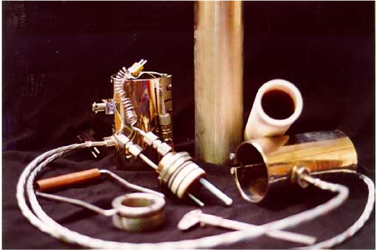
Abb. 4.2: Einzelteile, aus denen der Autoklav besteht
