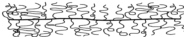
Abb. 3.1: Schematischer Aufbau eines Polymakromonomers
