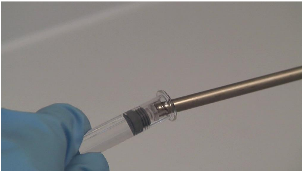
Abbildung 107: Einschrauben der kurzen Gewindestange.
