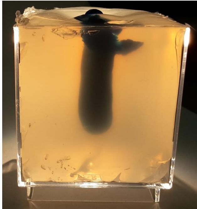
Abbildung 72: Injektion der Lösung in Silikon.
