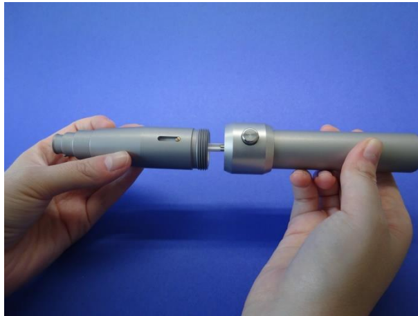
Abbildung 34: Lösen der Untereinheit von der Aktivatoreinheit.
