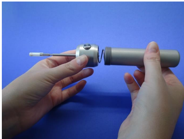
Abbildung 35: Ablösen der Aktivatoreinheit von der Auslöseeinheit.
