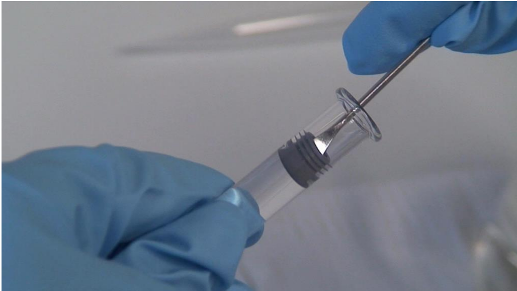
Abbildung 106: Luftblasenfreies Verschließen der Spritze.
