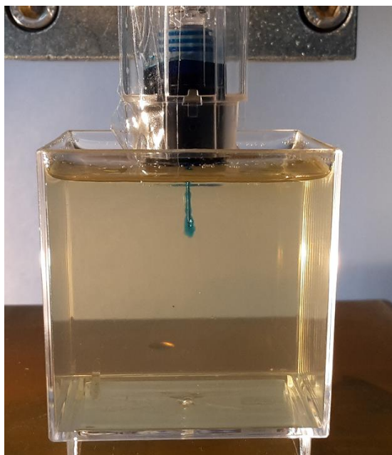
Abbildung 68: Injektion in ballistische Gelatine Typ 3, 20 %.
