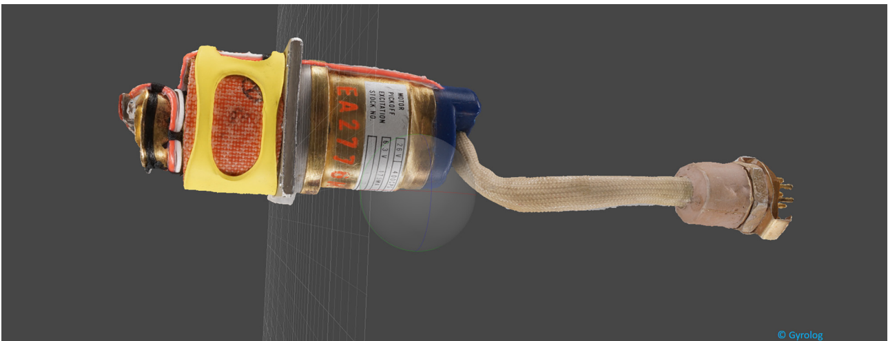
Abb. 3: Photogrammetrische Erfassung des mechanischen Kreiselinstrumentes »Golden Gnat« des Forschungsprojektes Gyrolog an der Universität Stuttgart (Abb.: Gyrolog).
