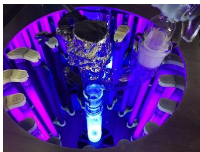
Abbildung 73: Photochemischer Reaktionsaufbau unter Verwendung des Rayonet-Photoreaktors.
