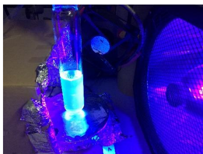
Abbildung 75: Photochemischer Reaktionsaufbau unter Verwendung einer UV-A Energiesparlampe.
