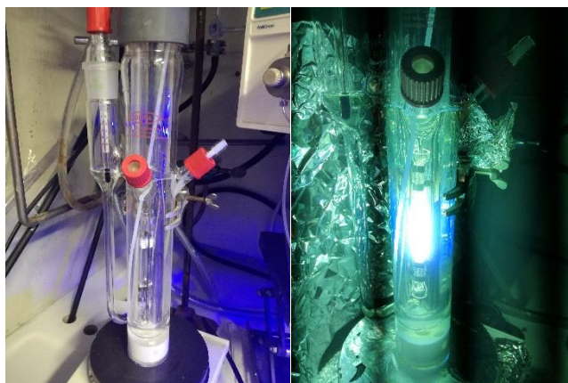
Abbildung 74: Photochemischer Reaktionsaufbau unter Verwendung des Hg-Tauchreaktors.
