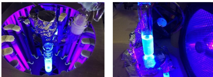
Abbildung 32: Reaktionsaufbau des Rayonet-Photoreaktors (links) sowie des UV-A Schwarzlichtstrahlers (rechts) für die intramolekulare Zyklisierung von 343 .
