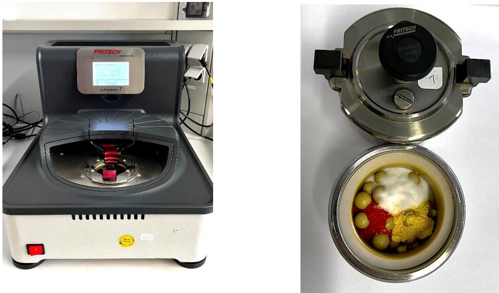
Abbildung 76: Mechanochemischer Reaktionsaufbau unter Verwendung der Pulverisette 7 Premium Line.
