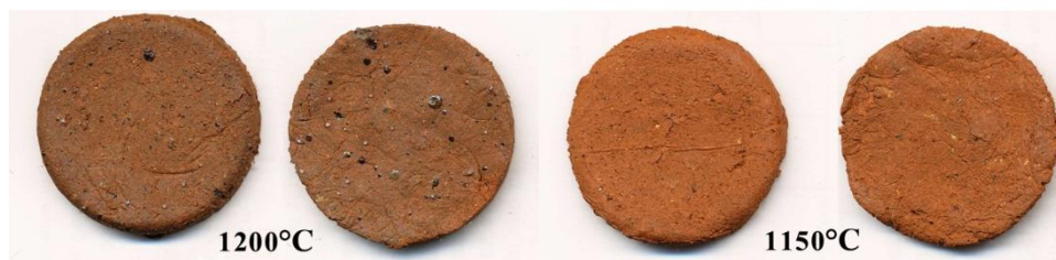
d: Schwarze Glasblasen auf der Keramikoberfläche.
