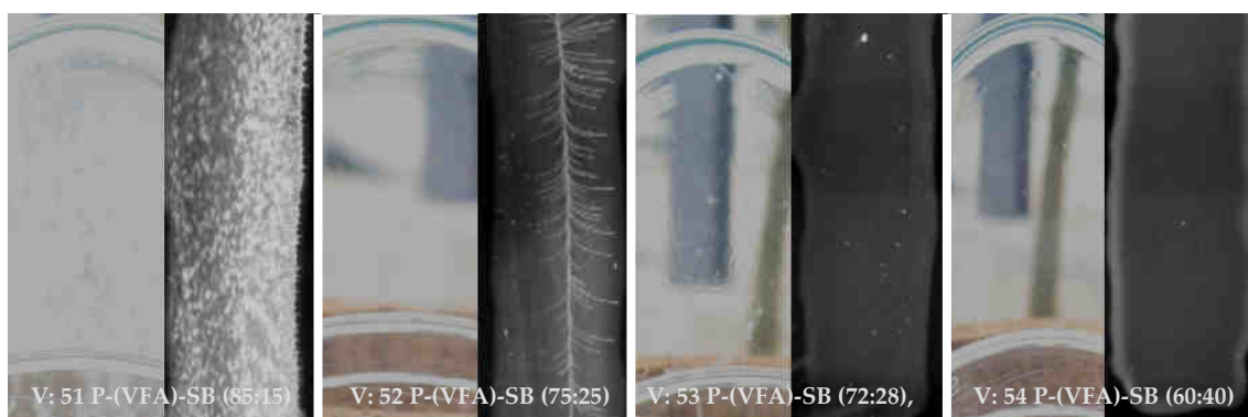
Abbildung 7-1: P-(VFA)-Kern-Schale-Filme mit unterschiedlichen Kern/Schale-Verhältnissen: V: 51 P-(VFA)-SB (85:15), V: 52 P-(VFA)-SB (75:25), V: 53 P-(VFA)-SB (72:28), V: 54 P-(VFA)-SB (60:40), bei Normallicht (jeweils linkes Bild) und unter UV Licht (jeweils rechtes Bild).
