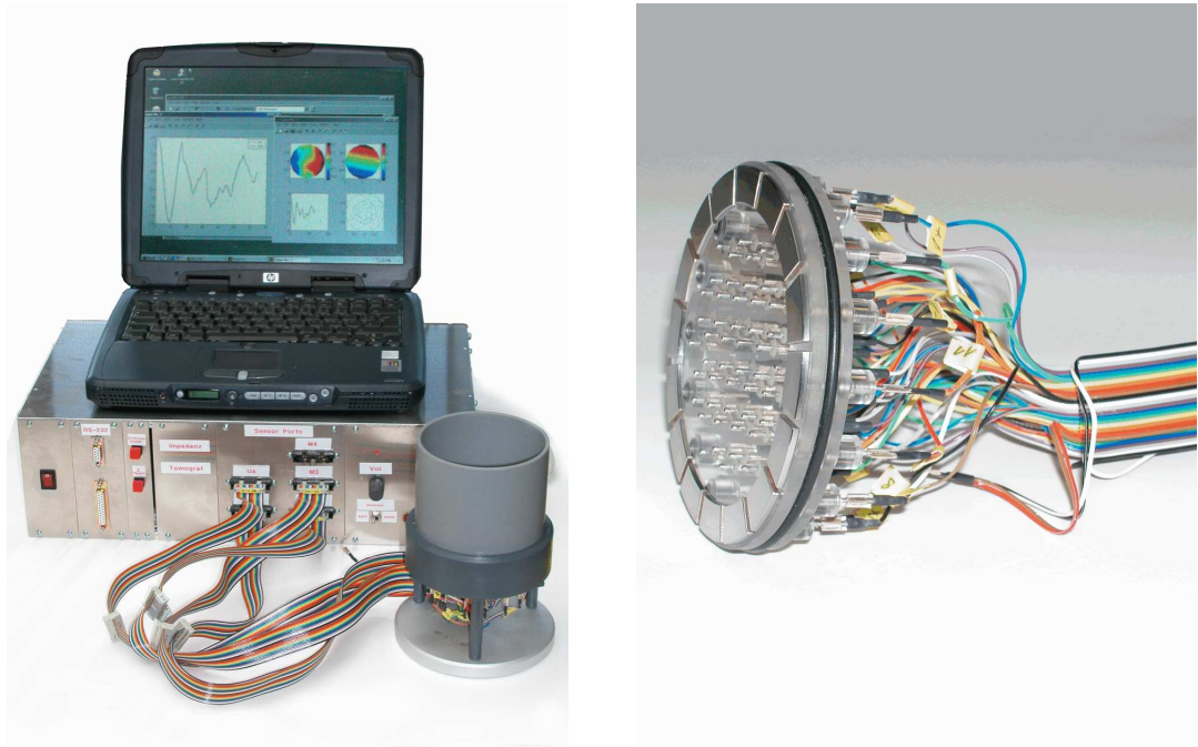
Abbildung 7.1: Links: Das System aus Computer, Tomograph und Meßstempel. In einem Behälter, an dessen Boden der Meßstempel angebracht ist, kann Wasser eingefüllt werden. Mit einer Metallkugel im Wasser wird der Effekt der Leitfähigkeitserhöhung studiert. Rechts: Der runde Meßstempel, mit 16 äußeren Anregungselektroden und 48 inneren Potentialmessen Elektroden.
