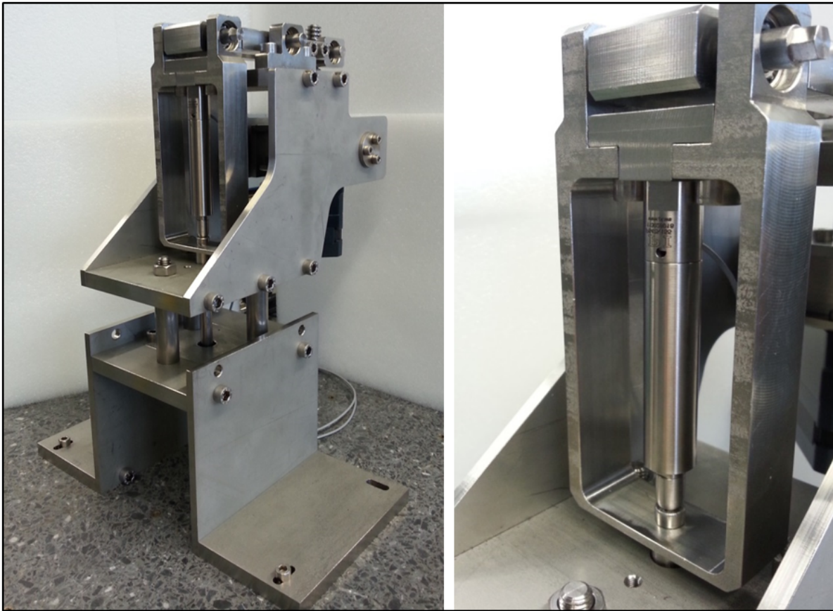
Abb. 6.25: Prototyp der aus Edelstahl gefertigten Antriebsmechanik mit integriertem Piezoaktor des Typs P-843.30.
