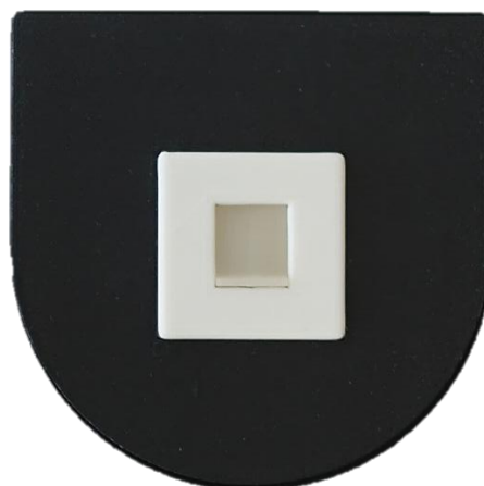
Abbildung 14 Halter in Adapter mit Probekörper mit Ausrichtung der Bruchstelle nach unten
