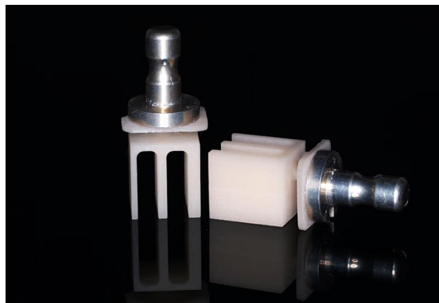
Abbildung 9 Keramikblöcke direkt nach dem Schleifprozess
