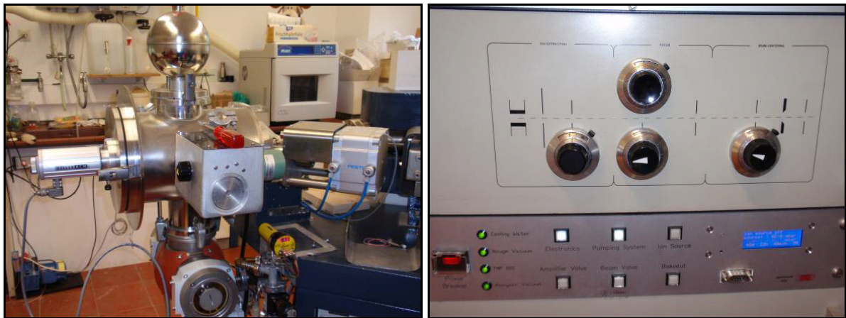
Abbildung 31: Ionenquelle der TIMS der Arbeitsgruppe um Prof. Dr. Stefan Hölzl, LMU-München (links); rechts: Bedienungselement zur Fokussierung des Ionenstrahls
