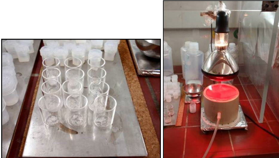
Abbildung 55: Rückstand der Haarproben nach der Veraschung (links) und die Trocknungsanlage bestehend aus Rotlichtlampe und Absaugeinrichtung (rechts)
