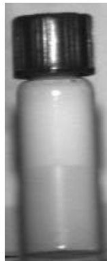
Abbildung 3.65: 1:1 Mischung der BASF Proben in einer 4 ml Küvette aus Quarzglas (Supelco). Die kleineren BASF170 schwimmen auf den BASF210.
