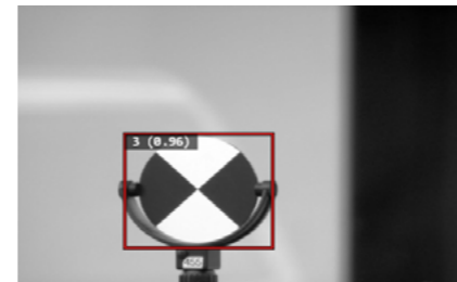
Validierung der Targetdetection (Schwarz-/Weiß-Target) mit Konfidenz; Foto: i3mainz, CC BY-SA 4.0
