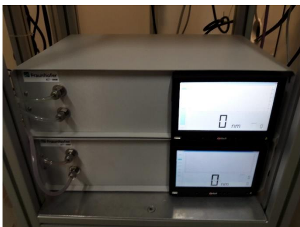
Abbildung 30: Detailansicht der flowDLS Analysengeräte. Oben: vor Filtration; unten: nach Filtration für das finale Produkt.
