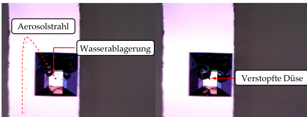
Abbildung 7.33: Bildausschnitt eines Videos der Aerosolproduktion mit Blick in die Düsegrube. 200 Hz Dosierfrequenz, 35 \mu\text{m} Düse. Links: Aerosolstrahl in Rot markiert. Fortschreitende Wasserablagerung in der Grube; Rechts: Moment, in dem die Wasserablagerung die Düse berührt und Aerosolproduktion einbricht.
