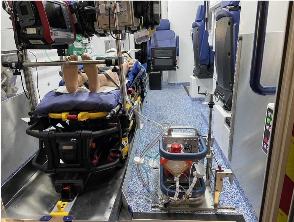
Abbildung 14 ECMO/ECLS-System mit Arretierung im Innenraum des ITW
