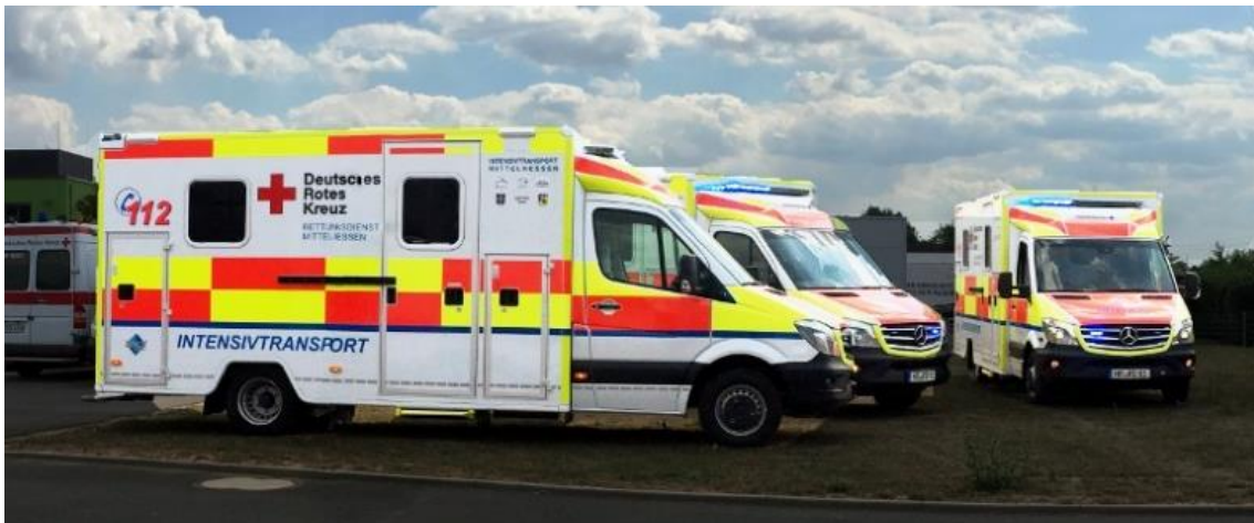
Abbildung 16 Intensivtransportwagen nach DIN EN 1789, Typ C
