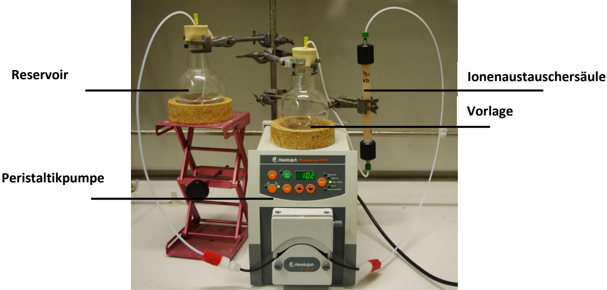
Abbildung 70: Experimenteller Aufbau für kontinuierliche Adsorptions- und Desorptionsprozesse. [123]
