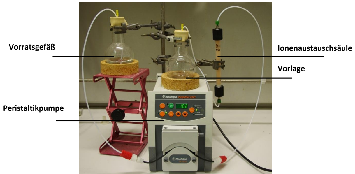
Abbildung 22: Apparativer Aufbau für die Prozessführung bei Adsorptions- und Desorptionsexperimenten im kontinuierlichen Prozess.
