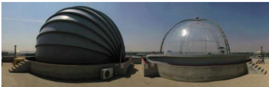
Abbildung 5.1: Der europäische Photoreaktor EUPHORE mit einer geschlossenen und einer offenen Simulationskammer.
