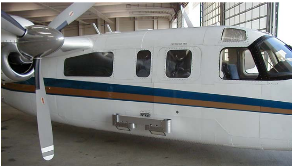
Abbildung 3-1: Das ATI-Antennen-System des AeS-1 ist auf einem Flugzeug (Rockwell Turbine Commander) in Flugrichtung hintereinander montiert.
