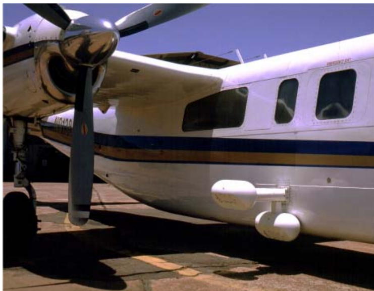
Abbildung 3-2: Das XTI-Antennen-System des AeS-1 ist auf einem Flugzeug (Rockwell Turbine Commander) senkrecht zur Flugrichtung und in Blickrichtung montiert.
