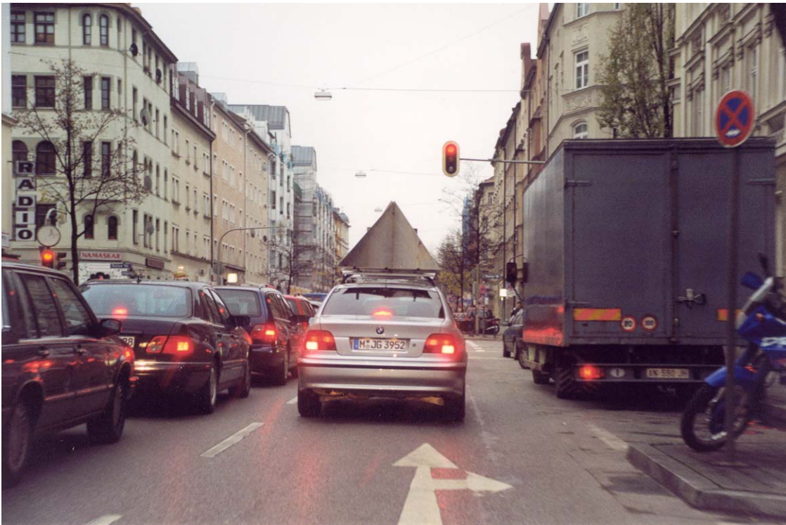
Abbildung 7-12: Floating Car mit Corner Reflektor in der Rosenheimer Straße, an der Lichtsignalanlage quert die Pariser Straße, 11.11.99.
