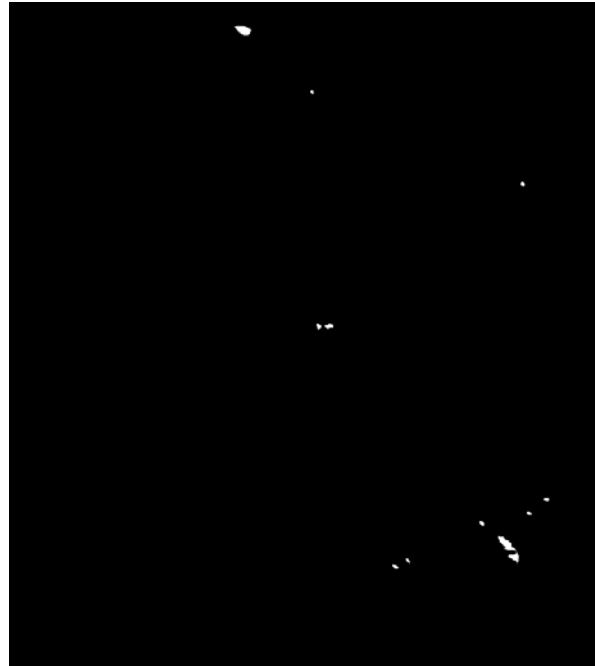
Abbildung 5-14: Ausschnitt aus der Stadtaufnahme. Als Fahrzeuge festgestellte Objekte (weiß) nach Überprüfung anhand einer Reihe von Kriterien. Viele detektierte Objekte sind keine Fahrzeuge und wurden dem Hintergrund zugeordnet (vergleiche Abb. 5-13).
