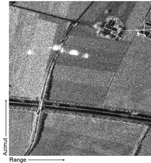
Abbildung 5-6: Ausschnitt aus dem Amplitudenbild der Autobahnaufnahme (11.11.99, 08:57 MEZ). Die sich bewegenden Objekte sind als weiße oder graue Punktwolken teilweise von der Fahrbahn versetzt abgebildet.
