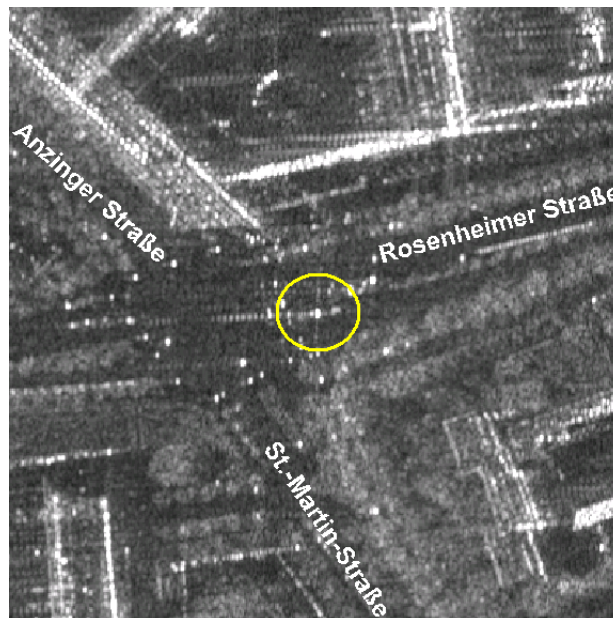
Abbildung 7-9: Ausschnitt aus dem Amplitudenbild 06:43 MEZ mit dem Floating Car Nr. 5 in der Rosenheimer Straße. Deutlich ist das markante Rückstreusignal des Corner Reflektors in Form eines Kreuzes mit einem hellen Punkt in der Mitte zu sehen (mit gelben Kreis markiert). Gut zu erkennen sind in Form von dicken hellen Punkten die Ampelanlagen rund um die Kreuzung. Das Amplitudenbild ist in der Slant Range-Geometrie.
