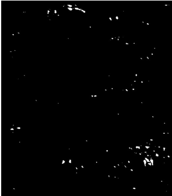
Abbildung 5-13: Ausschnitt aus der Stadtaufnahme. Maskierung aller Objekte, die detektiert wurden. Bewegte Objekte sind weiß und der Hintergrund schwarz dargestellt. Dieser Ausschnitt zeigt dasselbe Gebiet wie Abb. 5-9 und 5-10.
