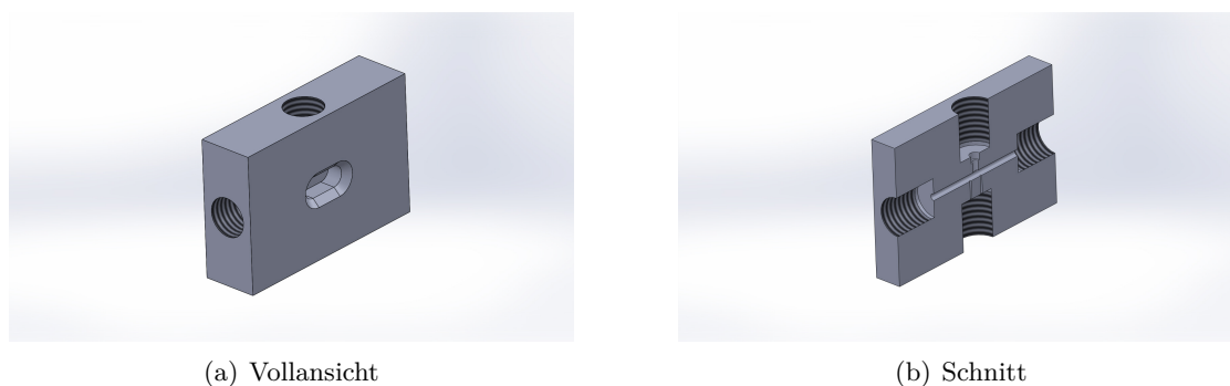
Abbildung 3.2: 3D-Konstruktion einer einfachen Durchflusszelle mit schraubbarer Referenzelektrode und schraubbarer Abdichtung von Anode und Kathode, siehe Text
