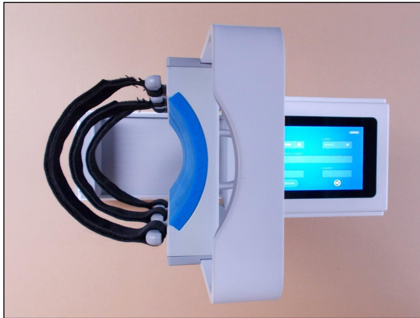
Abbildung 16 Schienbeinfixierung im Arthrometer, Ansicht von oben (ELMAKO, Iffezheim)
