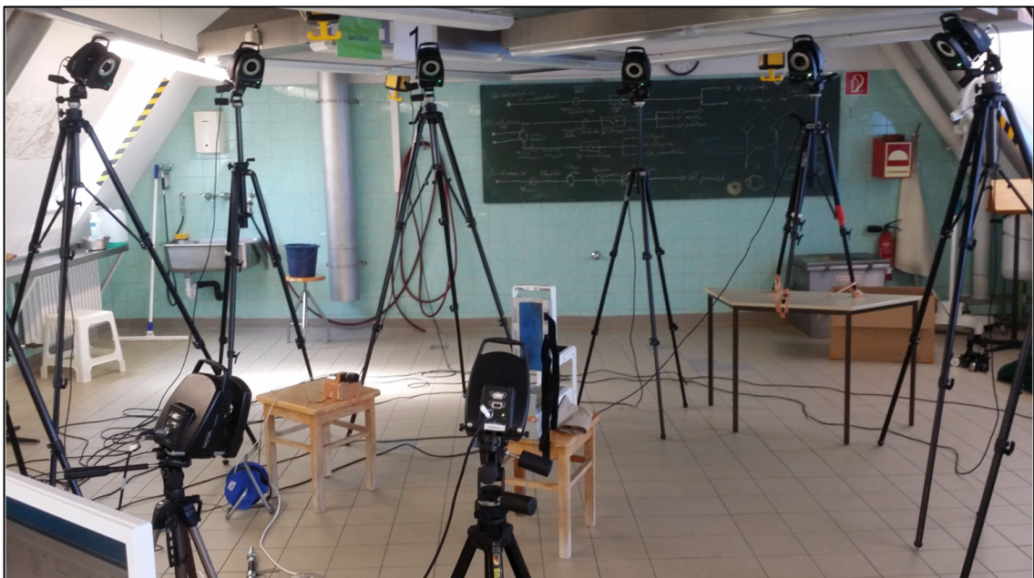
Abbildung 24 Versuchsaufbau der dreidimensionalen Bewegungsanalyse
