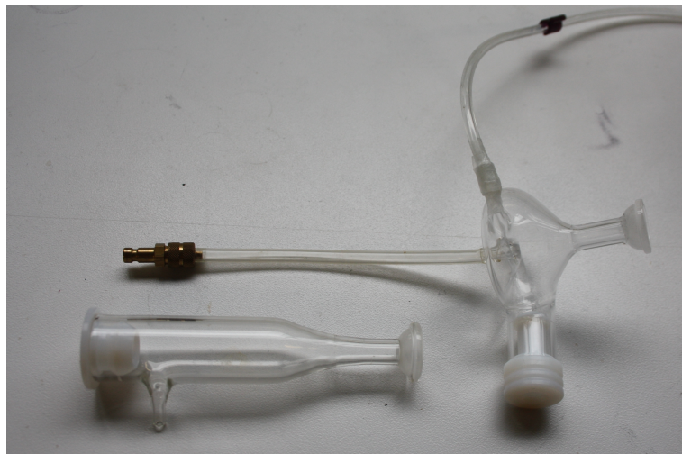
Abbildung 5.8: Links: die Aerosoltransportkammer, ein durch die Glastechnische Werkstatt des Institutes für Anorganische und Analytische Chemie der Uni Mainz erstelltes Bauteil; rechts: eine Zyklonsprühkammer (Fa. AHF). [66]
