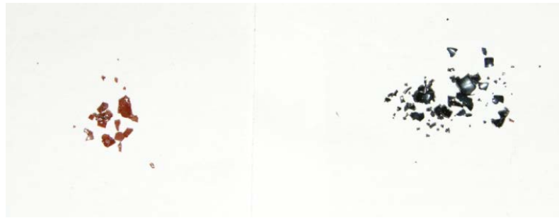
Abbildung 81: Farbliche Änderung der TiO_2 -Partikel vor der Pyrolyse (links) und nach der Pyrolyse (rechts).
