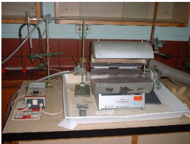
Abbildung 3.19: Foto des zum Ausglühen der Elektroden verwendeten Ofens mit eingesetztem Quarzrohr.
