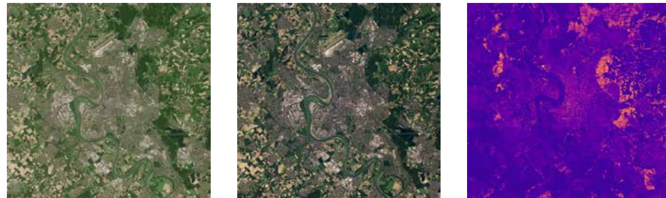
Abbildung: Eingabe-Fernerkundungsdaten für das Modelltraining (v.l.n.r.): Sentinel-2 (Low-Resolution [10m/Pixel]), PlanetScope (High-Resolution [3m/Pixel]), nDOM (Ground Truth [0,5m/Pixel]); Ausschnitt: Düsseldorf.
