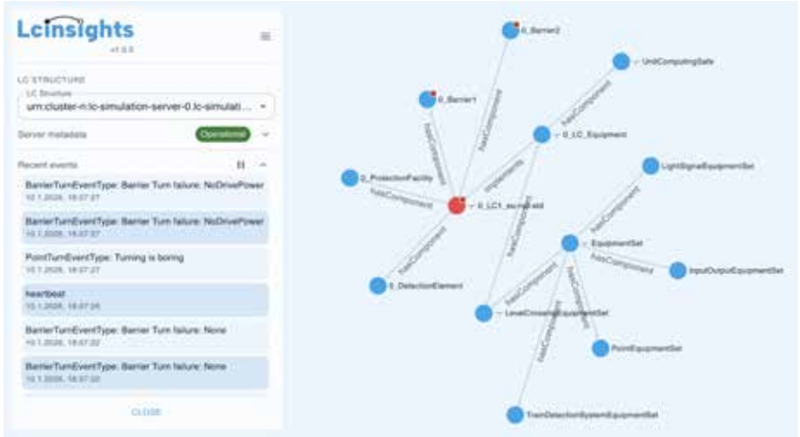
Grafik unten: Visualisierung der Infrastrukturkomponenten und Ereignisse eines simulierten Bahnübergangs in der Webanwendung LcInsights auf Basis von OPC-UA-Daten. Grafik: Yannik Bock, Sebastian Gebel, Karim Ouhammi und Danny Staus, CC BY-SA 4.0
