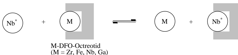
Abb. 58: Schema des chemischen Gleichgewichtes der Metallverdrängung in M-DFO-Octreotid-Systemen mit geträgertem ^{95}\text{Nb} ( \text{Nb}^* )
