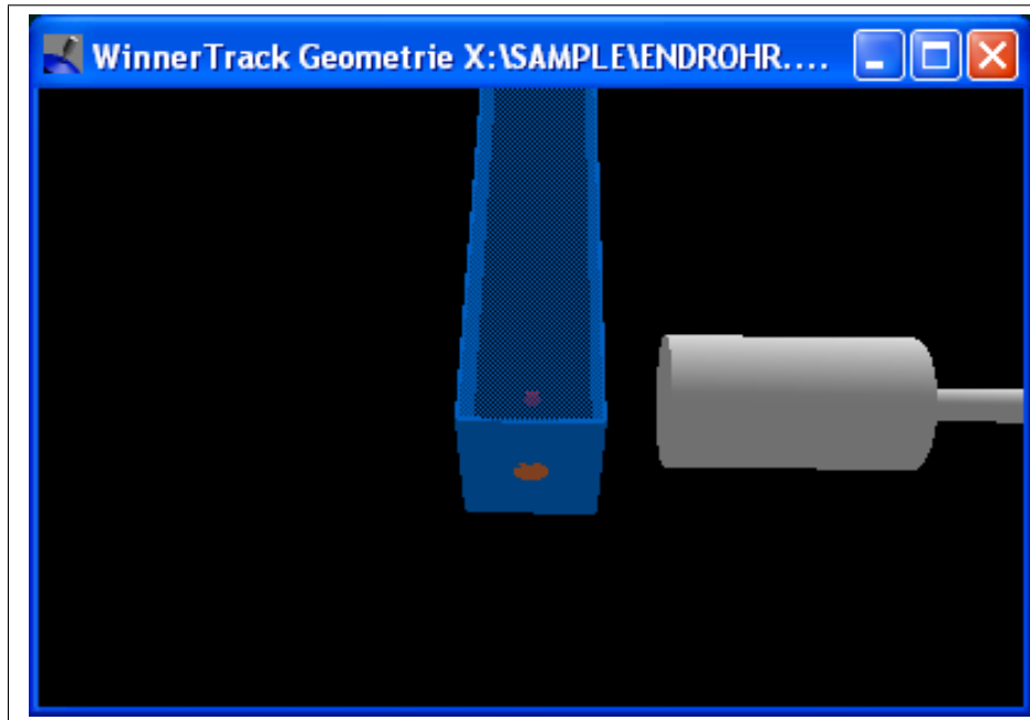
Abbildung 5.3: Darstellung der Messgeometrie. Der Deckel des Endrohrs ist transparent dargestellt.
