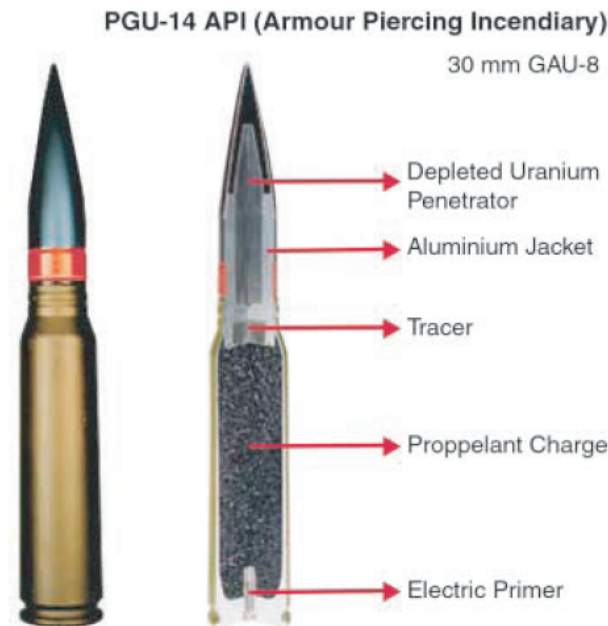
Abbildung 16: Darstellung eines panzerbrechenden Urangeschosses (United Nations Environmental Programme, 2001). Zu sehen ist der Kern aus DU (depleted uranium penetrator), der die panzerbrechende Wirkung erzeugt.
