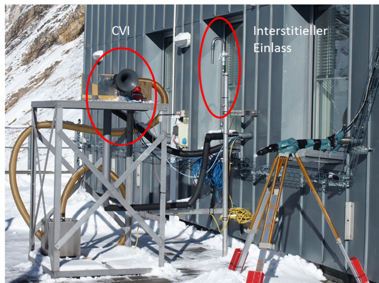
Abbildung 5.19: Foto der Einlasssysteme auf der Messterrasse der UfS (links: CVI; rechts: Interstitieller Aerosoleinlass).
