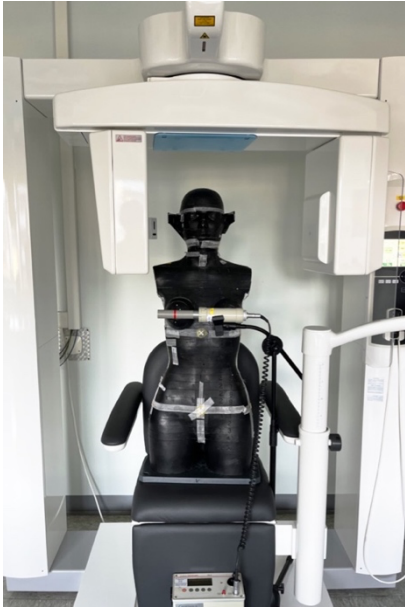
Abbildung 39: Versuchsaufbau für die Hauptversuche im 3D Accuitomo – Messung auf Höhe der rechten Mamille ohne Röntgenschürze
