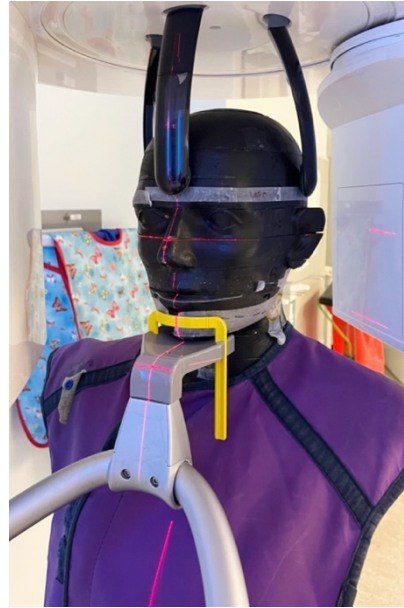
Abbildung 42: Versuchsaufbau für die Hauptversuche im Orthophos SL – Messung auf Höhe der rechten Mamille mit Röntgenschürze
