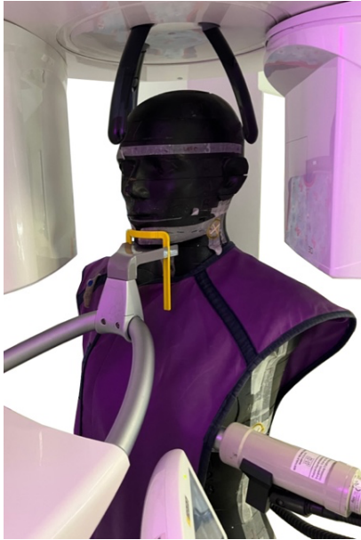
Abbildung 35: Versuchsaufbau im Orthophos SL zur Messung auf Höhe der linken Mamille mit Röntgenschürze
