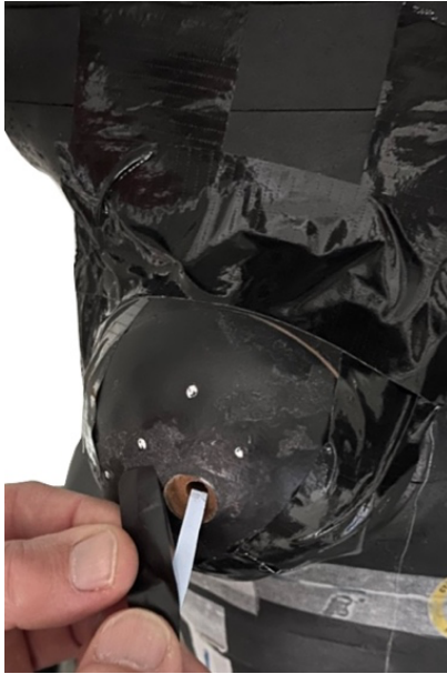
Abbildung 27: Der Versuchsaufbau zur Durchdringungsfähigkeit der Streustrahlung nach zentral. Die zugeschnittene Speicherfolie wird nach zentral durch den Schraubkanal in die Brust des Phantoms eingeführt
