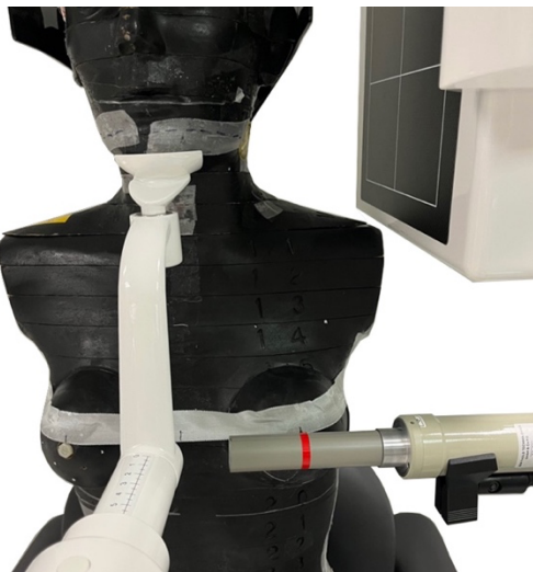
Abbildung 22: Positionierung des TOL-F Dosimeters an Position 2 im 3D Accuitomo
