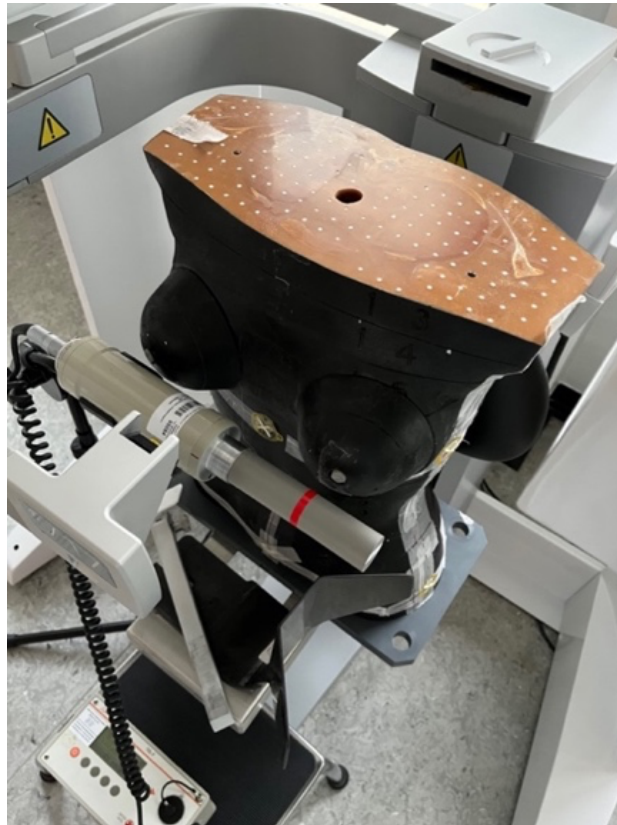
Abbildung 24: Versuchsaufbau zur Untersuchung des Kopfes als Streustrahlungsquelle, exemplarisch gemessen am OP 3D Vision
