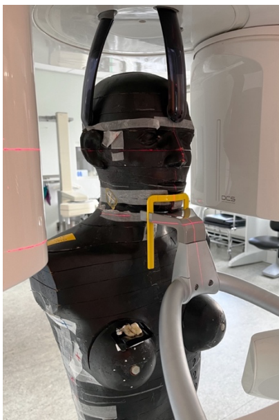
Abbildung 29: Versuchsaufbau zur Demonstration der Streustrahlung auf der Höhe der Brust mittels extrahierten Zähnen und Speicherfolie – von frontal
