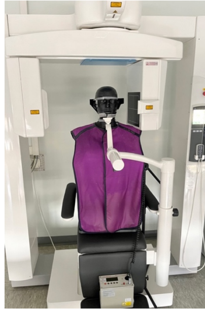
Abbildung 40: Versuchsaufbau für die Hauptversuche im 3D Accuitomo – Messung auf Höhe der rechten Mamille mit Röntgenschürze
