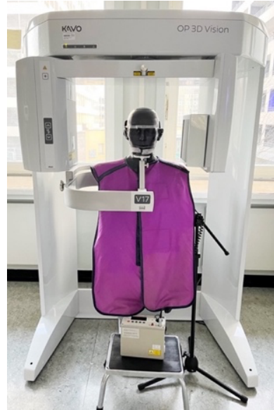
Abbildung 38: Versuchsaufbau für die Hauptversuche im OP 3D Vision – Messung auf Höhe der rechten Mamille mit Röntgenschürze
