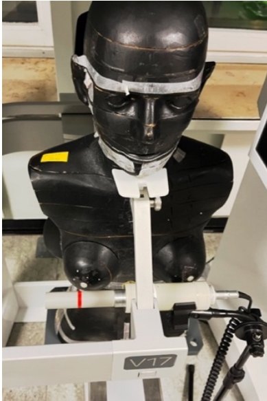
Abbildung 37: Versuchsaufbau für die Hauptversuche im OP 3D Vision – Messung auf Höhe der rechten Mamille ohne Röntgenschürze
