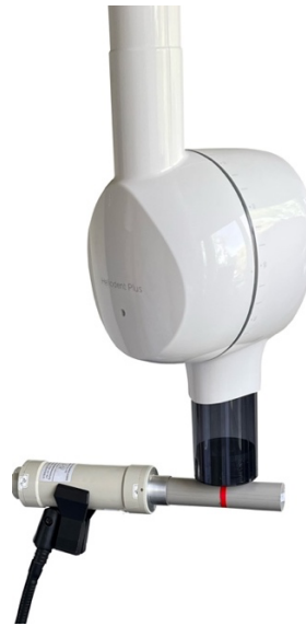
Abbildung 18: Versuchsaufbau zum Erstellen der Eichkurve mit dem TOL-F Dosimeter und dem Intraoralstrahler der Firma Dentsply Sirona
