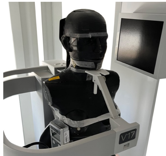
Abbildung 23: Positionierung des X5C Plus Dosimeters an Position 5 im OP 3D Vision
