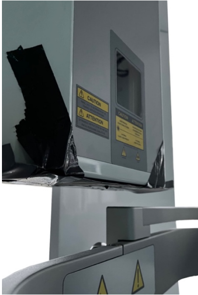
Abbildung 25: Die Blende des OP 3D Vision wird mit Bleifolie abgeschirmt – Ansicht von lateral
