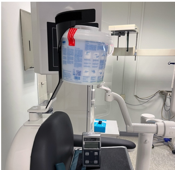
Abbildung 19: Versuchsanordnung zum Erstellen der Eichkurve mit dem X5C Plus Dosimeter im 3D Accuitomo
