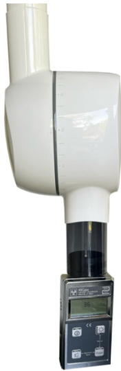
Abbildung 17: Versuchsaufbau zum Erstellen der Eichkurve mit dem X5C Plus Dosimeter und dem Intraoralstrahler der Firma Dentsply Sirona
