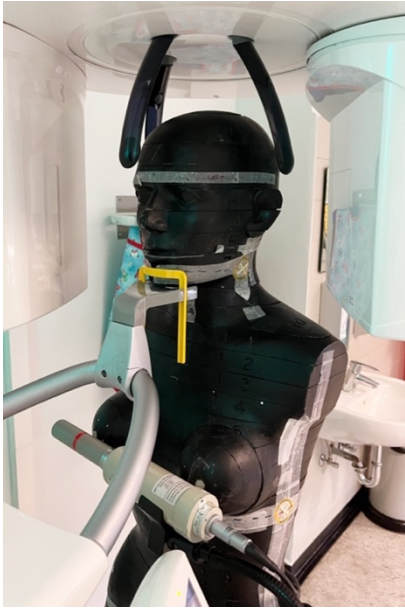
Abbildung 41: Versuchsaufbau für die Hauptversuche im Orthophos SL – Messung auf Höhe der rechten Mamille ohne Röntgenschürze
