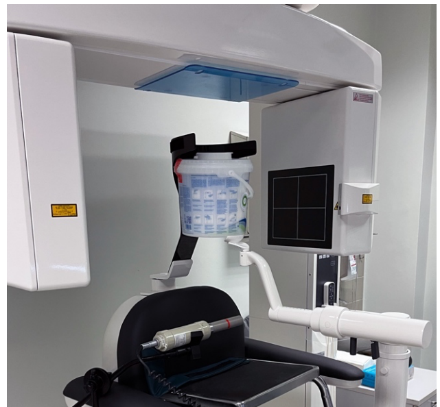
Abbildung 20: Versuchsanordnung zum Erstellen der Eichkurve mit dem TOL-F Dosimeter im 3D Accuitomo
