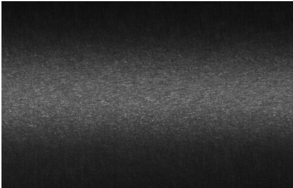
Abbildung 5.2: Die unverarbeiteten Rohdaten eines Bildsensors. Das Streulicht ist wegen der geringen Intensität auf den mittleren Bildbereich konzentriert. Die Anzahl der Messwerte wird dadurch verringert, aber auch kleine Intensitäten sind dadurch noch vermessbar.
