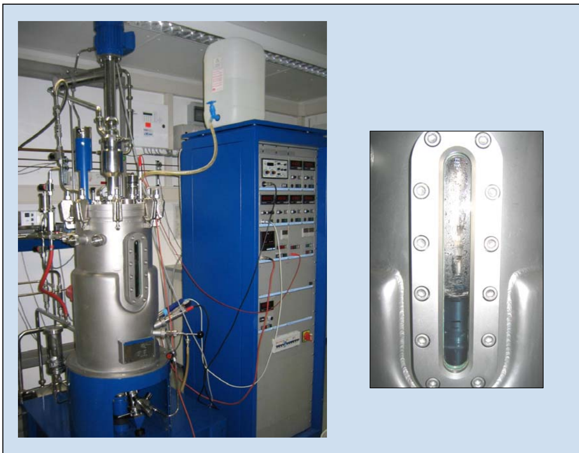
Abb. 2.1: Pilotfermenter mit Rühraufsatz und Steuereinheit. Durch das Sichtfenster (vergrößerte Darstellung rechts) konnte der Zustand der Kultur überwacht werden.
