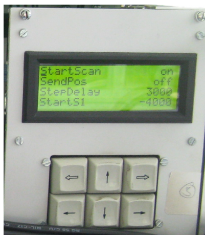
Abbildung 3.1: Bedienelemente der V25. Mit den Pfeiltasten in der Mitte wird zwischen Einträgen auf der gleichen Menüebene gewechselt und die einzelnen Ziffern von Zahlen verändert. Mit den dünnen Pfeilen nach Rechts und Links wird die Menüebene und zwischen den Ziffern einer Zahl gewechselt. Der Doppelpfeil nach Rechts bestätigt die Änderung eines Zahlenwerts.
