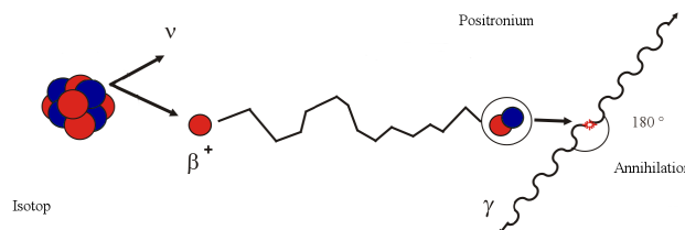
Abbildung 1.1: \beta^+ -Zerfall: Bildung des Positroniums und dessen Vernichtung
