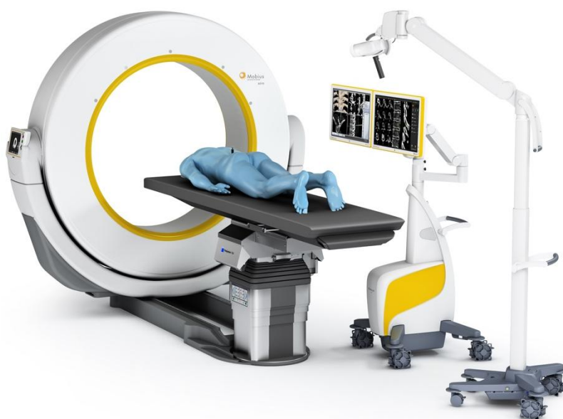
Abbildung 4: Darstellung eines iCT-Setups mit einem Patientenmodell in Bauchlage, wie es bei einer Operation der HWS angewandt wird. Erkennbar sind der "o"-förmige CT-Bogen, der OP-Tisch zur Patientenlagerung, der Bildschirm der dem Operateur die Navigation anzeigt und der Kamera die über optische Sensoren an dem speziellen OP-Instrumentarium und den dazugehörigen Referenzklemmen Bewegungen im Raum erkennen und über den Bildschirm dem Operateur in Fusion mit den CT-Daten anzeigen kann (Aufzählung von links nach rechts). - AIRO-Mobile Intraoperative CT-Scanner und Brainlab Curve System der Firma Brainlab AG, München, Deutschland.
