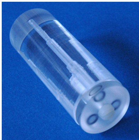
Abbildung 79: Bohrlochphantom aus Plexiglas mit Bohrungen von 2, 3 und 4 mm Durchmesser
