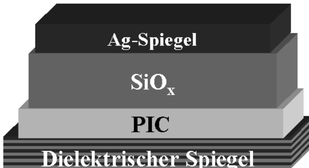
Abbildung 23: Aufbau des PIC/120nmSiO x /Ag-Mikroresonators (Resonator I)
