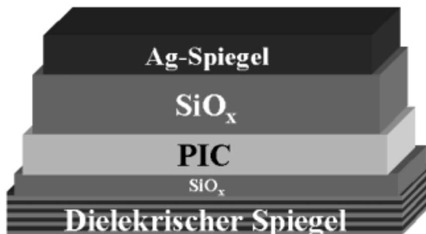
Abbildung 26: Aufbau des 30nm \text{SiO}_x /PIC/100nm \text{SiO}_x /Ag-Mikroresonators (Resonator II)
