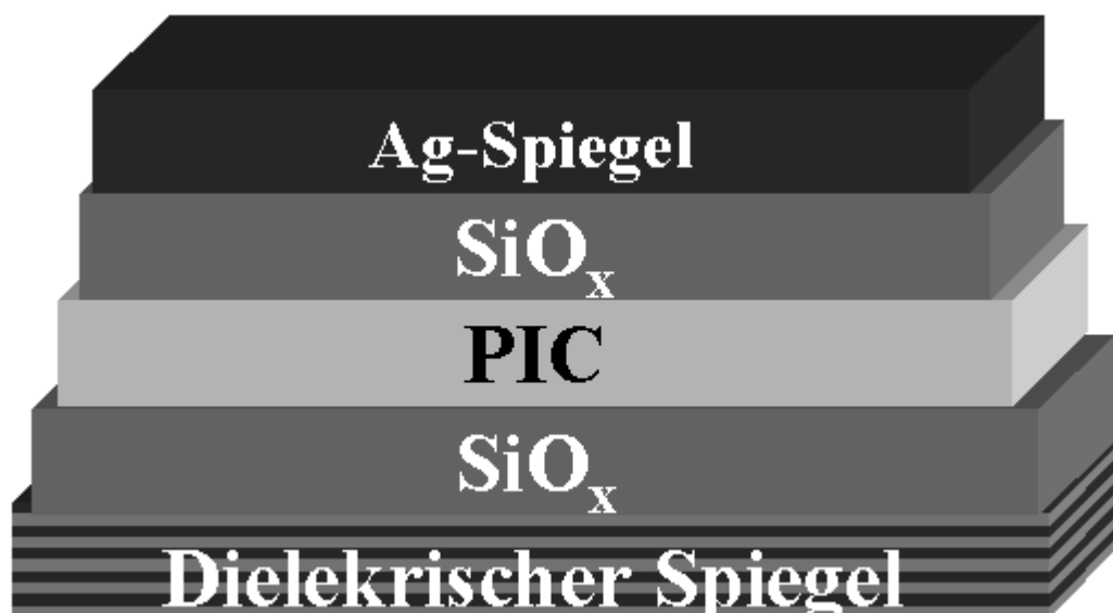
Abbildung 29: Aufbau des 60 nm SiO x /PIC/ 60 nm SiO x /Ag-Mikroresonators (Resonator III)
