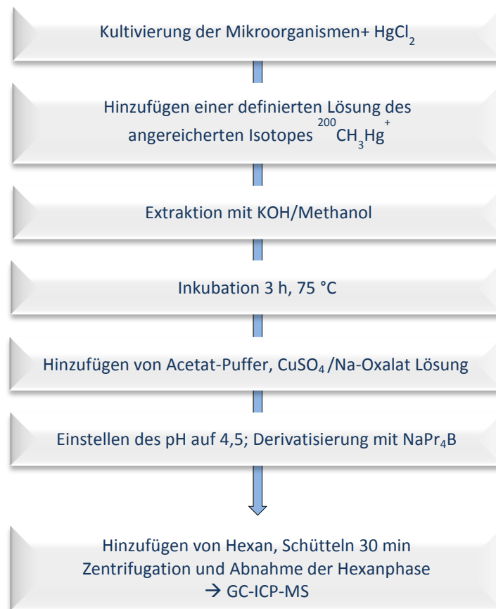
Abb. 8: Schema zur Probenvorbereitung für die Messung von MeHg in bakteriellen Flüssigmedien.
