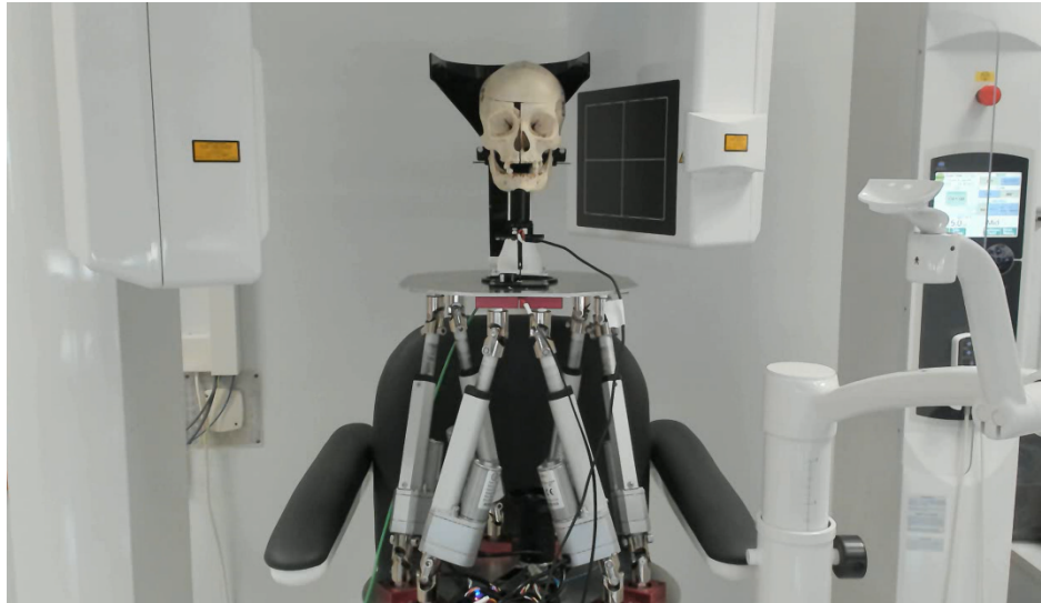
Abbildung 1: Experimenteller Aufbau für die Aufnahme der bewegungsbehafteten DVT Schädelaufnahmen. Durch die Nutzung der Stewart-Plattform ermöglicht sich eine freie Wahl der Bewegungsparameter.
