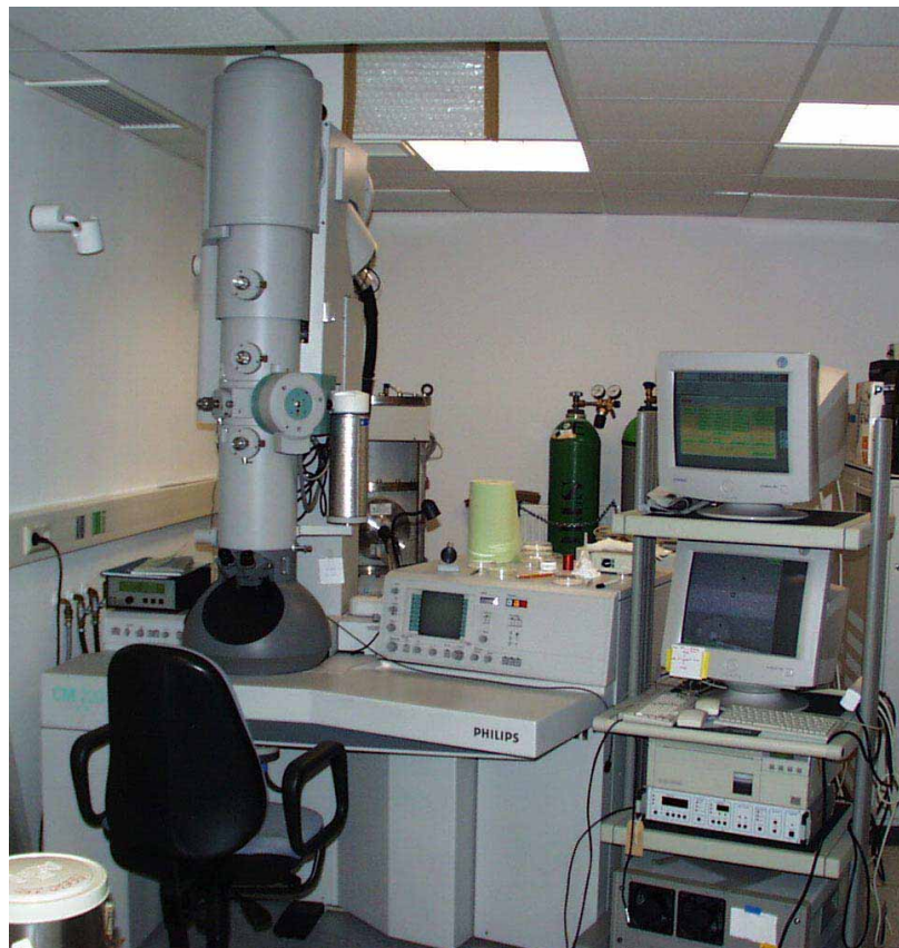
Abb. 3: Aufbau des Philips CM20 FEG Elektronenmikroskops (Standort Marburg, IMT)
