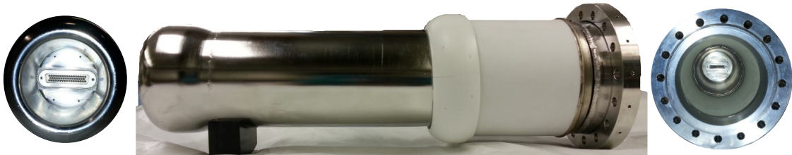
Abbildung 4.32: Photographie der Detektor-Cup zur Nachbeschleunigung der Protonen und Überwindung der Totschicht des Silizium-Drift-Detektors.
