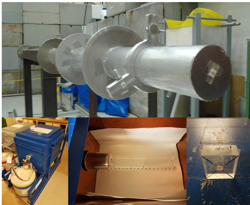
Abbildung B.3: Fotoserie zur Neutronenflussmessung am TRIGA Mainz. Oben: Aluminiumkonstruktion zur Fixierung der Sonden. Für die Bestrahlung wurde diese in ein Überrohr aus Aluminium eingeschoben. Unten: Standardisierter Messplatz zur Aktivitätsmessung der Sonden mittels einem HPGe-Detektor. Durch eine am HPGe-Detektorkopf fest angebrachte Steckschiene konnte eine reproduzierbare Absolutmessung durchgeführt werden.
