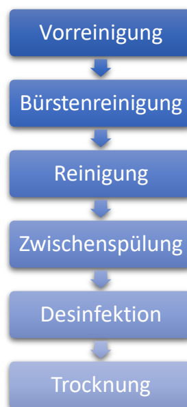
Abbildung 3 schematischer Ablauf Endoskopieaufbereitung
