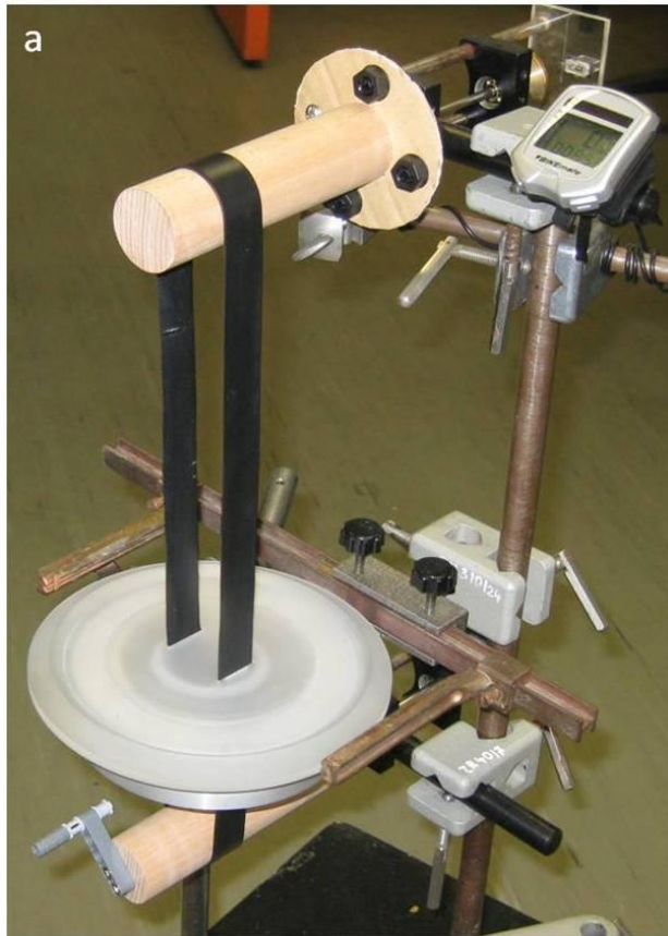
Abbildung 4: Versuchsaufbau der Laufbandversuche. (a) Die Apparatur besteht aus einem Laufband, das über zwei Walzen durch eine Plattform läuft. Die Kurbel ist aus Lego®-Teilen zusammengebaut, der Tacho lief in der letzten Version mit sechs Magneten, hier noch mit vier. (b) Apparatur mit der Standard-Umgebung, dem horizontalen Streifenmuster.
