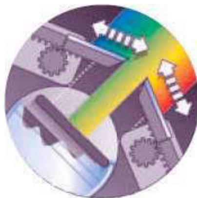
Abbildung 2.4: Schematische Darstellung eines CLSM-Detektors. Der Detektor ist durch seinen Aufbau in der Lage ausschließlich Licht einer bestimmten Wellenlänge aufzunehmen. Bis zu drei Signale können durch drei Detektoren gleichzeitig aufgenommen werden. Die Empfindlichkeit des Detektors wird durch die Spannung an der Photodiode eingestellt (Leica Microsystems Heidelberg GmbH, Mannheim).
