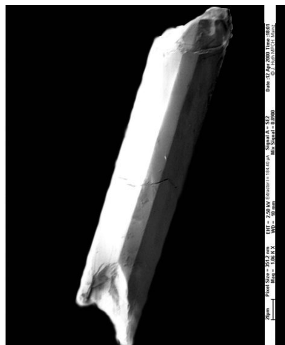
Abb. 6.6.8: Die interne Struktur typischer Zirkone des Augengneises P14 zeigt meistens magmatische Zonierung. Ererbte Kernbereiche sind selten. Trotz abgebrochener Pyramiden zeigt der Zirkonkörper (rechts) keine Hinweise auf transportbedingte Abrasion.
