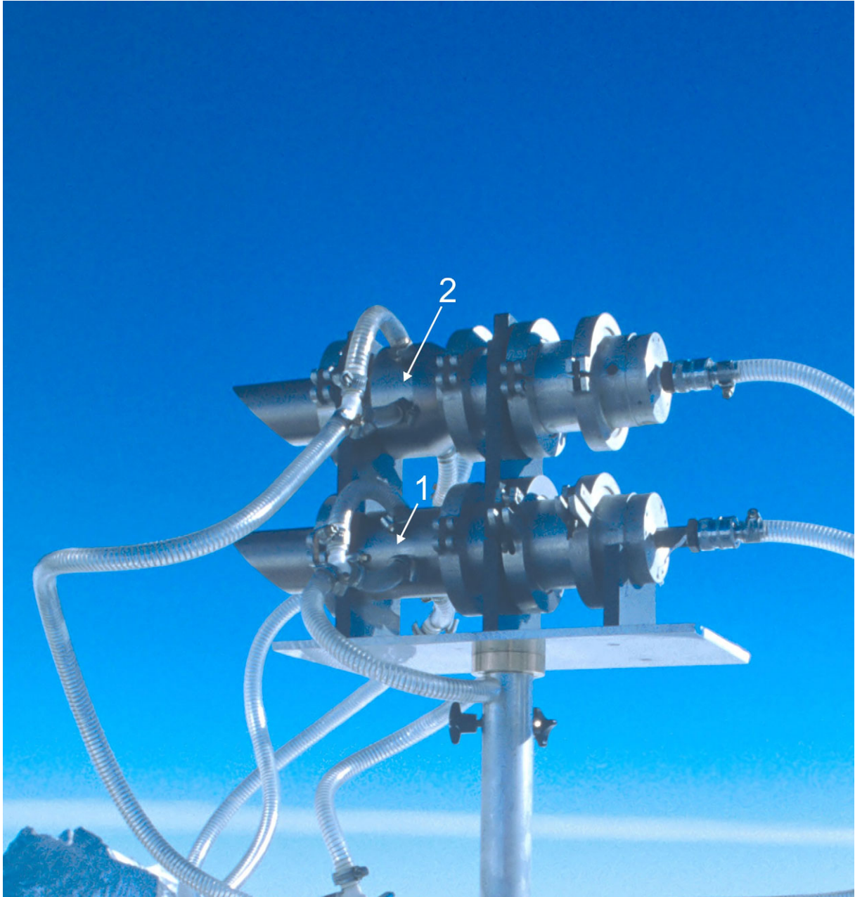
Abb. 7: DSI 6 und DSI 7 mit vorgeschalteten Konzentratoren und Schneeschutzblech (links) während CLACE 2000; der bauchige Konzentrator (2) ist die Weiterentwicklung des ursprünglichen (1)
