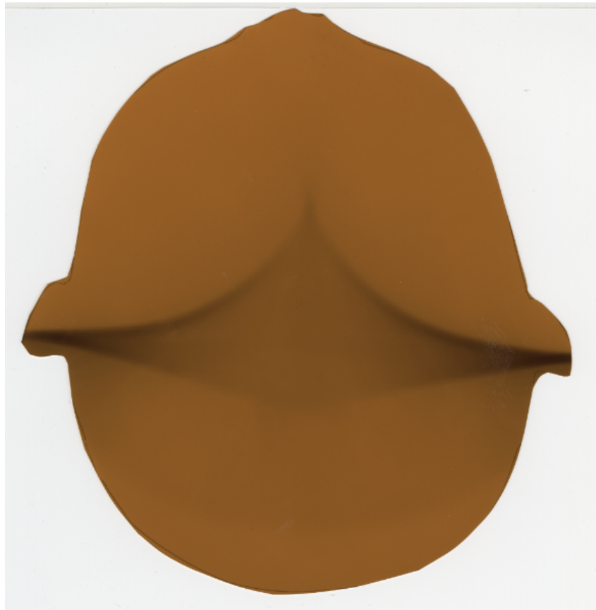
Abbildung 6: Abbildung 6 zeigt einen radiochromen Röntgenfilm, der auf den Querschnitt des Alderson-Rando-Phantoms zugeschnitten wurde. Die Schwärzung des Röntgenfilms zeigt beispielhaft die Dosisverteilung nach erfolgter Belichtung.
