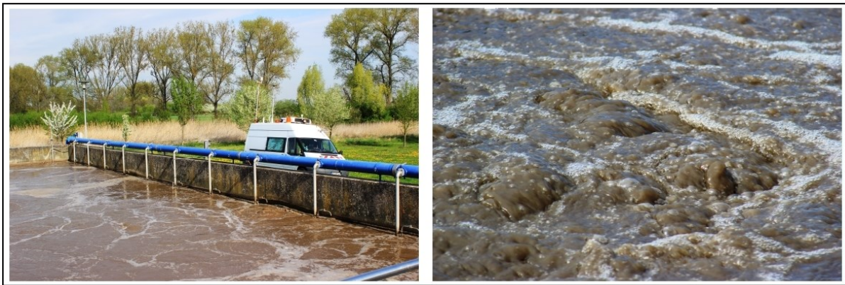
Abbildung 49: Standort des mobilen Aerosolforschungslabors zur Untersuchung der abwasserbürtigen Aerosolpartikel aus dem Belüftungsbecken einer kommunalen Kläranlage (links). Nahaufnahme der im Belüftungsbecken erzeugten Blasen mit anschließendem Bubble bursting (rechts). (Fotos: P. Faber)
