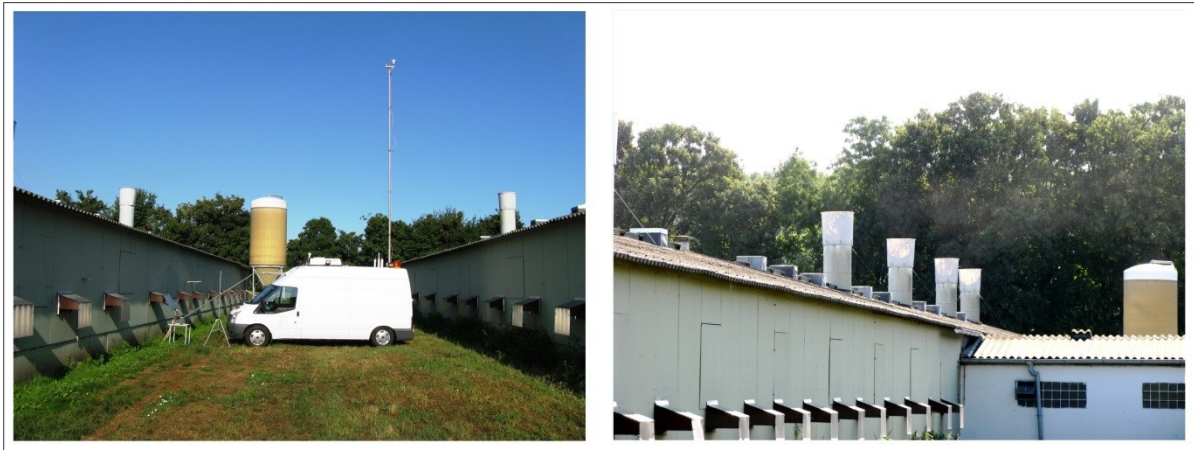
Abbildung 60: Standort des mobilen Messlabors zur Untersuchung der Emissionen im Stall eines Legehennenbetriebs (links). Durch die zentralen Abluftkamine werden die in der Stallluft vorherrschenden Aerosolpartikel in die Atmosphäre eingetragen (rechts). (Fotos: P. Faber)
