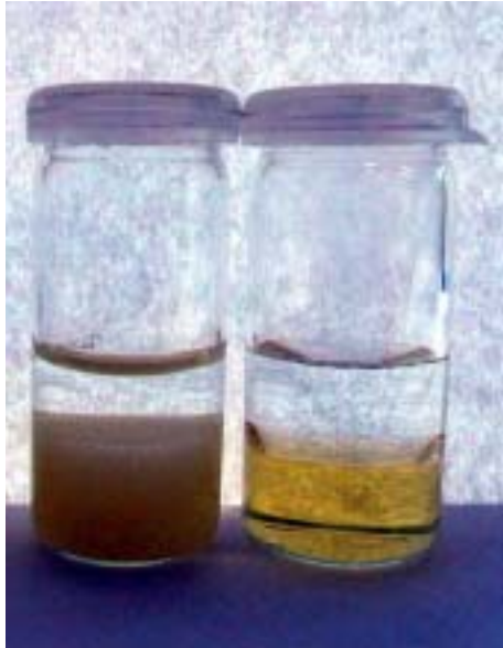
Abbildung 68: a) Phasenseparation von Chloroform/Wasser mit P3 (links) und mit P1 (rechts). b) Vergrößerung der unterbundenen makroskopischen Phasenseparation bei Polymer P3 (Balken = 100\mu\text{m} ).
